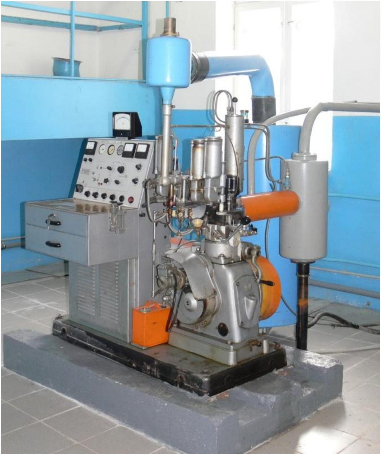
Рисунок 2.1 – Внешний вид установки УИТ-85 и схема расположения датчиков в камере сгорания
