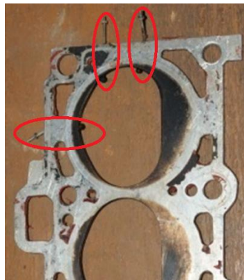
Рисунок 2.5 – Общий вид датчиков для исследования электропроводности пламени, в двигателе VAZ-2111: а) стальные датчики в керамической оболочке; б) алюминиевые датчики в головке блока цилиндров; в) алюминиевые датчики в специальной пластине.
