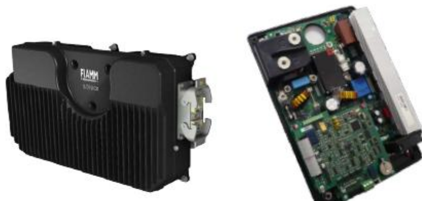
Рисунок 3.6 - Электронный модуль управления (BMS)
