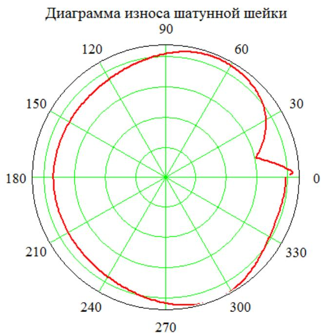
Рисунок 4.12 – Диаграмма износа шатунной шейки двигателя с турбонаддувом
