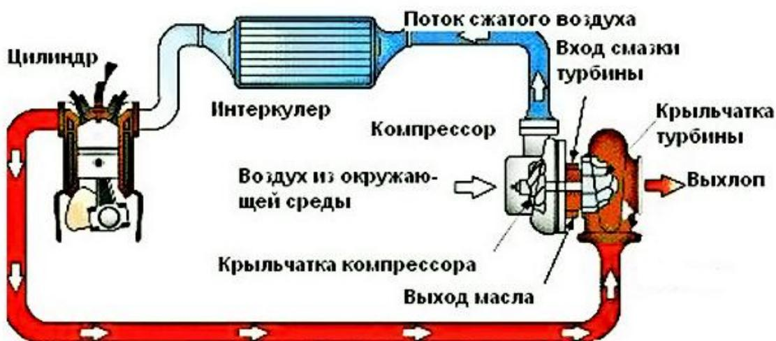
Рисунок 1.6 – Система турбонаддува
