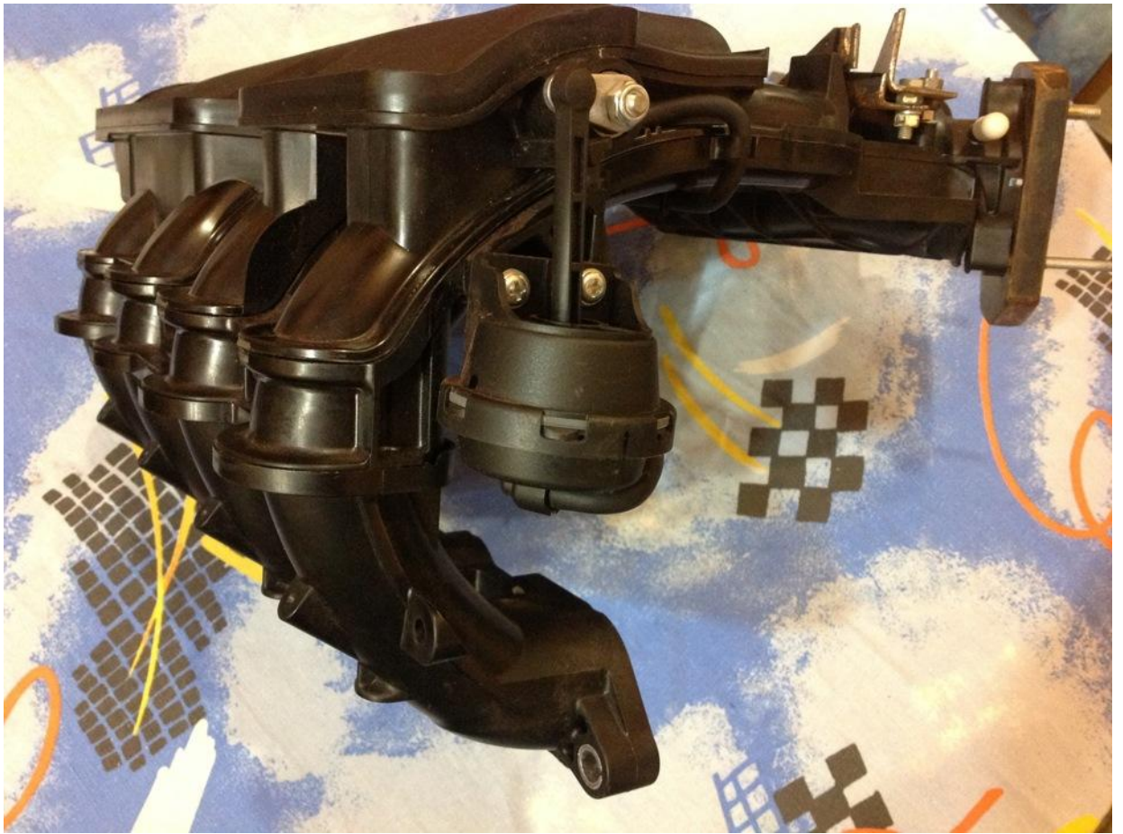
Рисунок 2 - Внешний вид нового ресивера двигателя ВАЗ 21127
