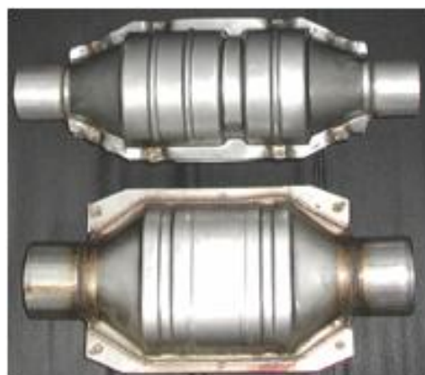
Рисунок 5.2 – Общий вид каталитических нейтрализаторов
