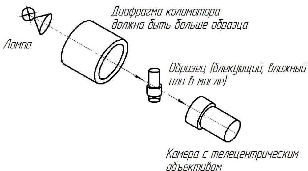
Рисунок 3.5 – Схема контроля бликующих деталей
