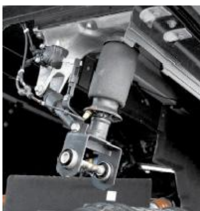
Рисунок 1.6 - Пневматическая четырёхточечная подвеска кабины RENAULT MAGNUM 2005 с двумя наклонными амортизаторами
