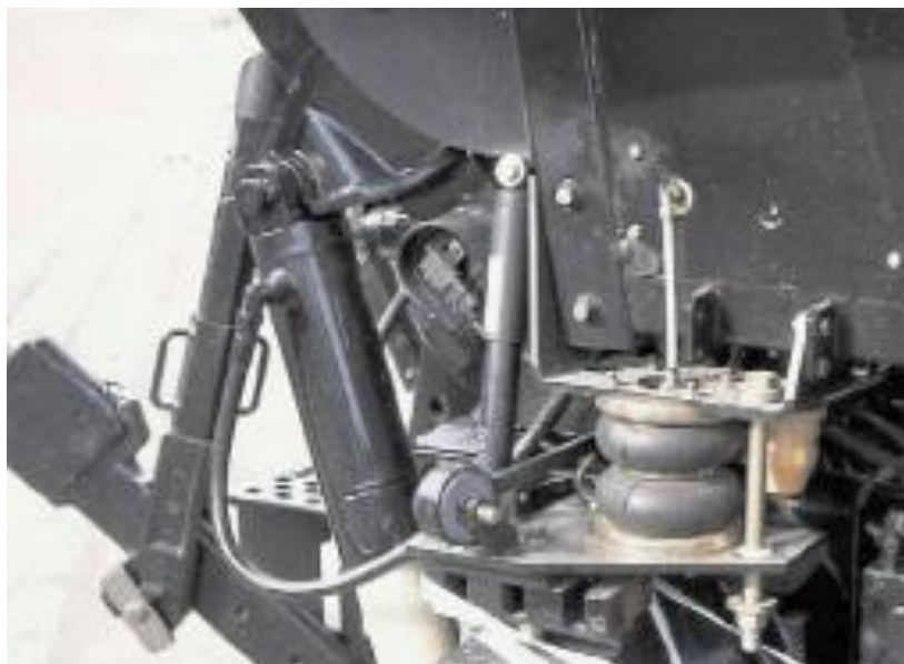
Рисунок 1.7 - Двухрежимная (полевой и дорожный) пневматическая подвеска кабины колёсного трактора МТ500В TECHSTAR Features
