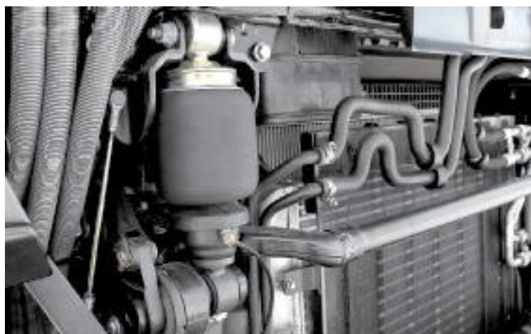
Рисунок 1.5 - Пневматическая подвеска кабины MERCEDES-BENZ Actros 4141K 8x4 со стабилизатором
