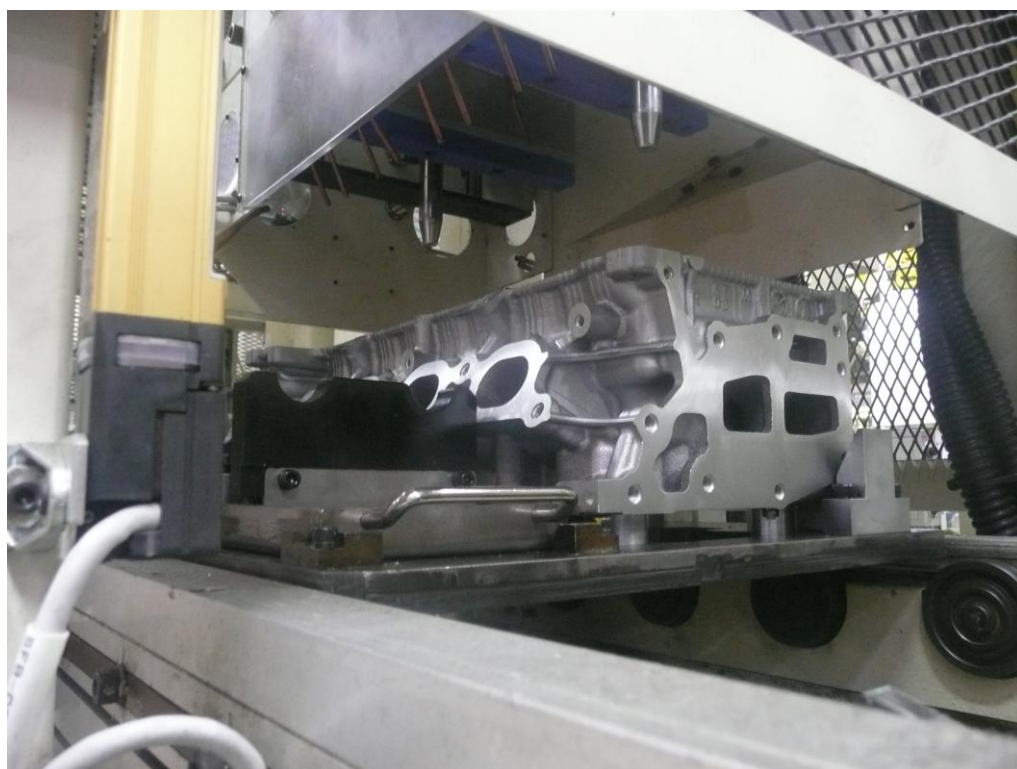
Рисунок 31 - Смазка втулок сразу 16 точек
