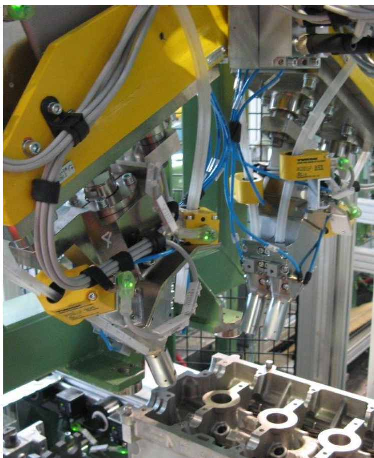
Рисунок 28 - станция для запрессовки сухарей
