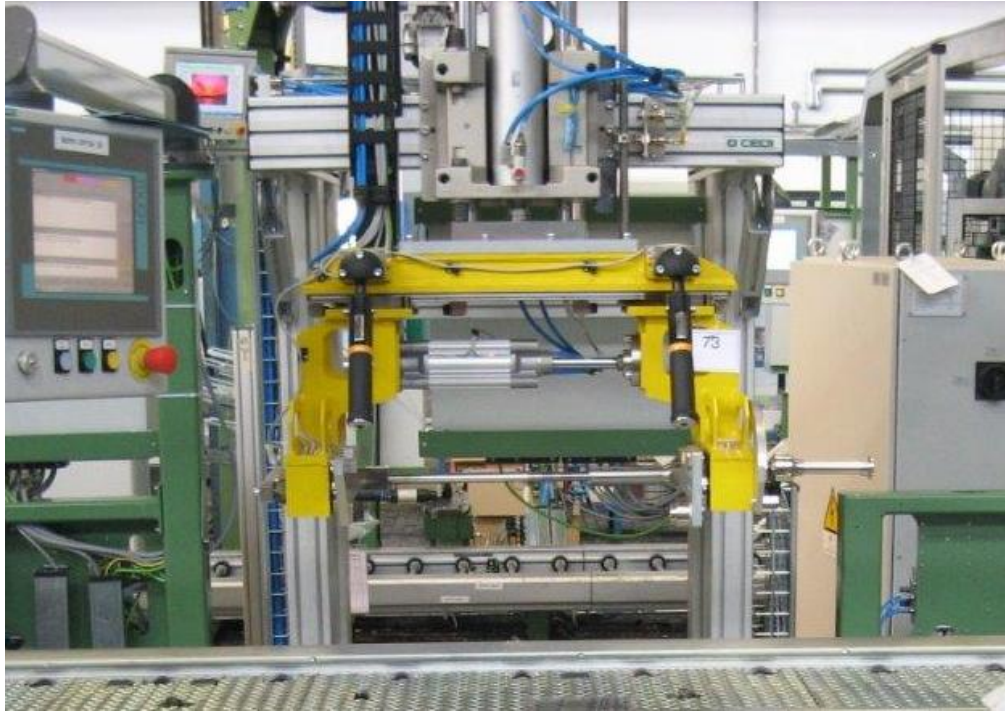
Рисунок 27 - устройство для переворота головы на станции установки клапанов
