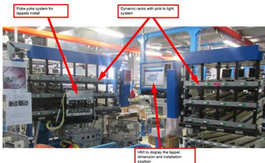
Рисунок 51 - Пример станции по выбору и установки толкателей
