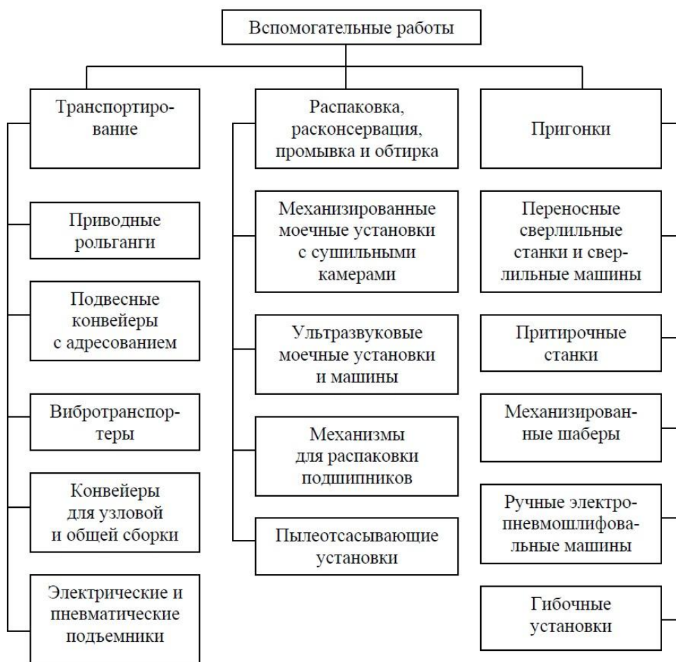
Рисунок 3 - Оборудование для вспомогательных работ
