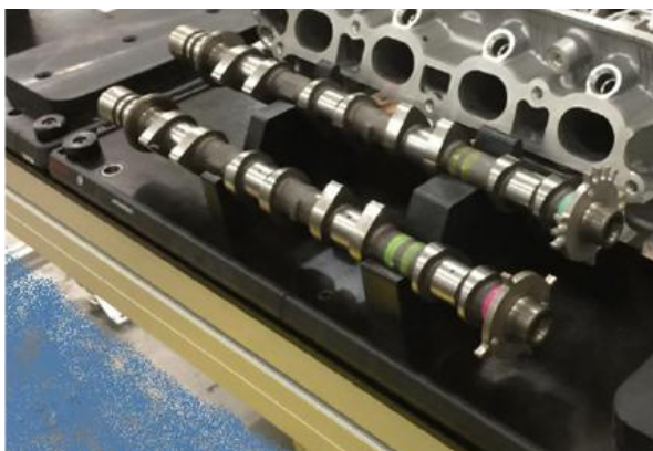
Рисунок 47 - Пример размещения распредвалов на паллете
