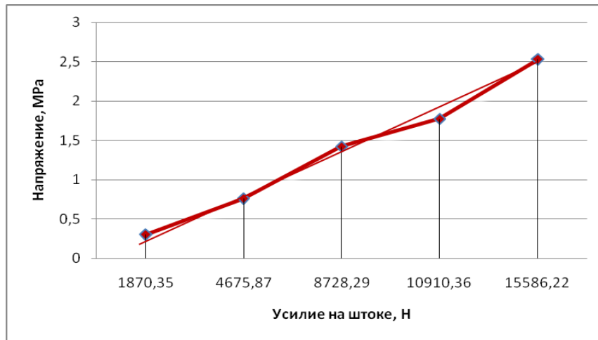
Рисунок 5.11 – Зависимость напряжения в месте давления хон-брусков от усилия, приложенного к штоку
