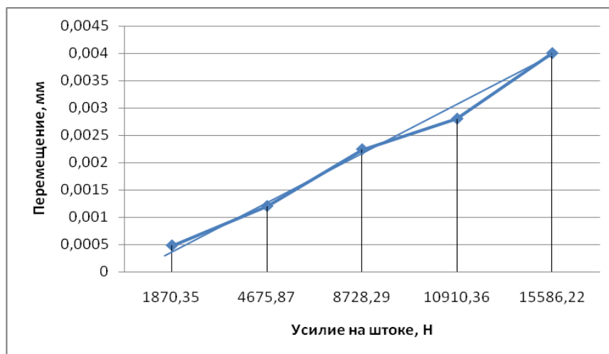
Рисунок 5.10 – Зависимость перемещение хон-брусков от усилия, приложенного к штоку
