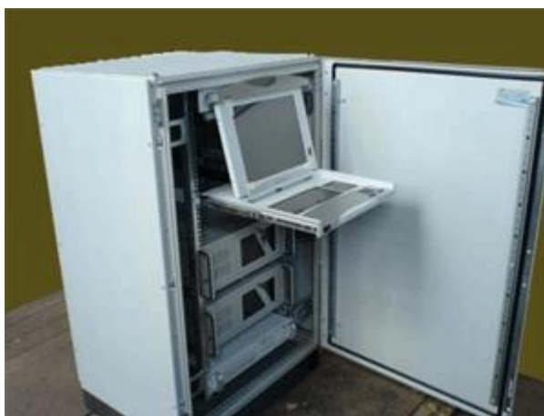
Рисунок 4.7 – Модуль системы, источник бесперебойного питания
