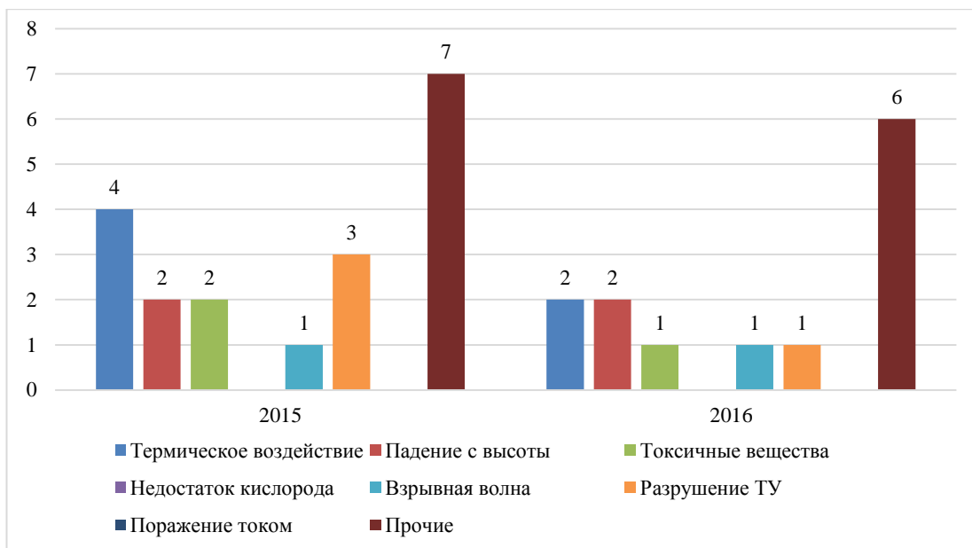
Рисунок 5 – Распределение несчастных случаев со смертельным исходом на объектах нефтегазодобычи по травмирующему фактору
