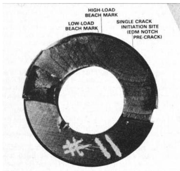
Рисунок 22 – Зоны на поверхности разломов на конце
