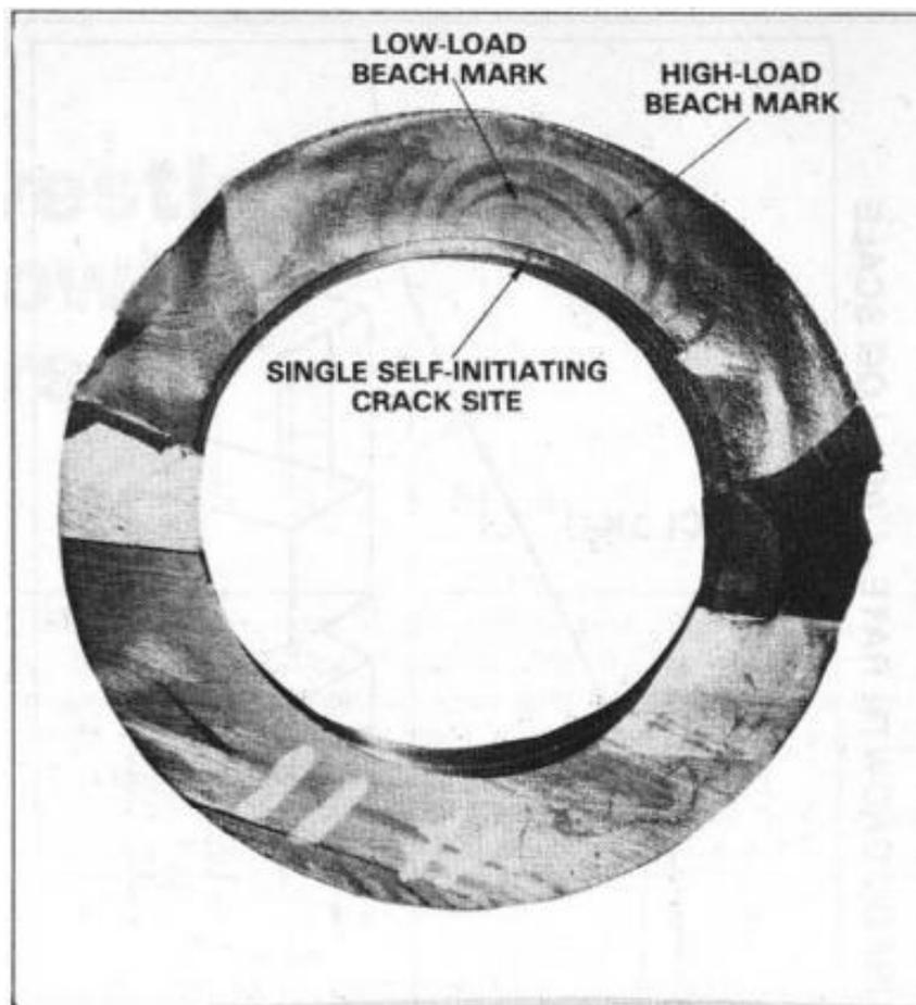
Рисунок 23 – Зоны на поверхности перелома на конце.
