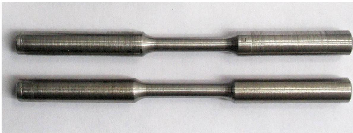
Рисунок 56 – Образцы для испытаний материала на растяжение
