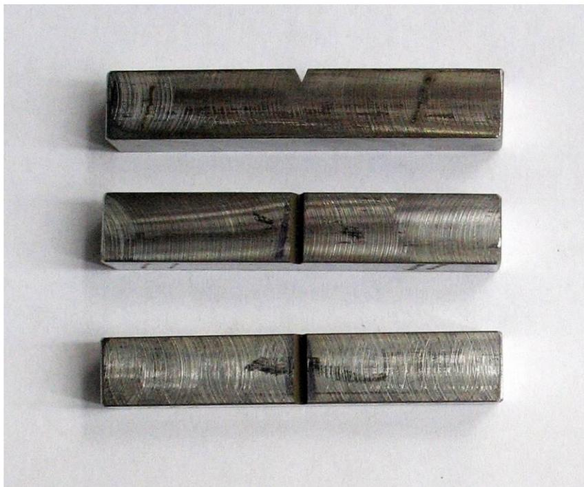
Рисунок 58 – Образцы для определения ударной вязкости KCV стали 40ХН2МА переводника № 4480
