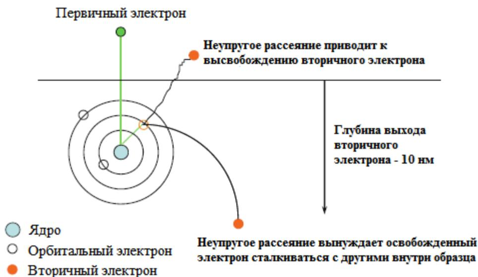
Рисунок 4 – Излучения, сгенерированные в результате взаимодействия первичного пучка электронов и образца.
