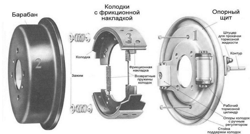
Рисунок 3.1 – Устройство тормозного барабанного механизма
