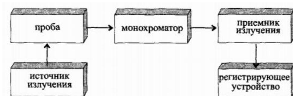
Рисунок 1.3 – Принципиальная схема оптического спектрометра.
