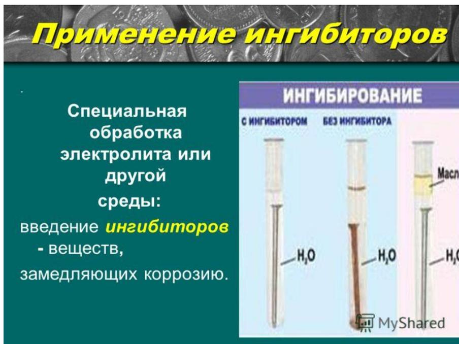
Рисунок 1.13 – Схема ингибиторной защиты
