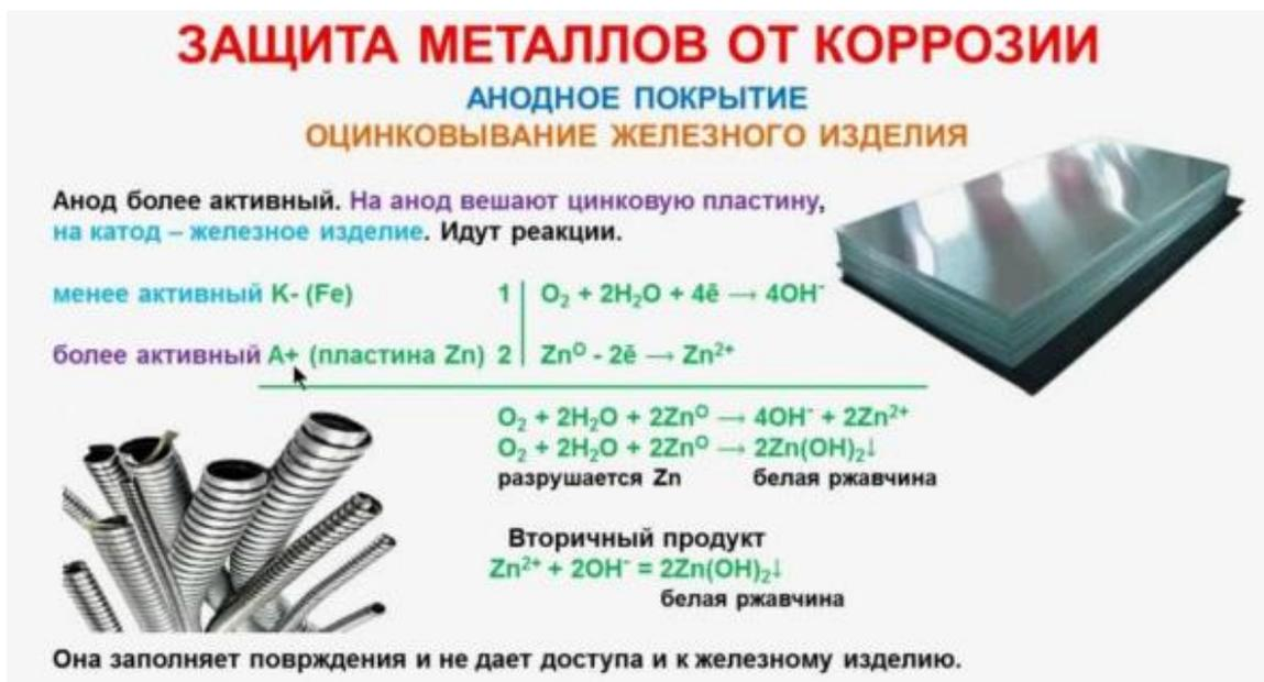
Рисунок 1.11 – Схема анодной защиты
