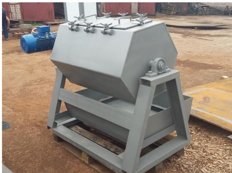
Рисунок 2.20 – Галтовочный барабан
