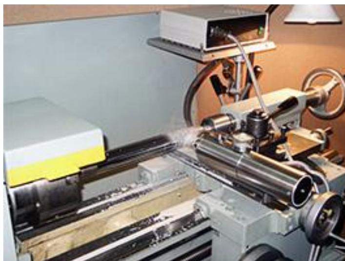
Рисунок 2.21 – Виброабразивная обработка
