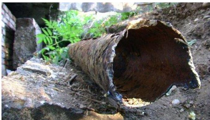
Рисунок 1.8 – Коррозионное разрушение трубопровода в почве
