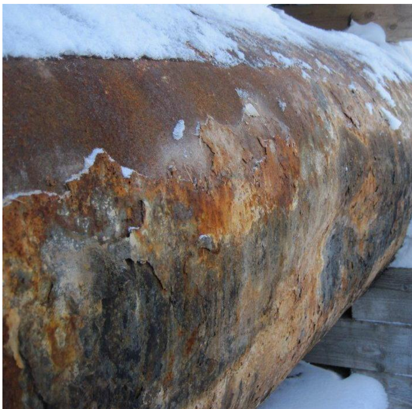
Рисунок 2.2 – Недостаточная коррозионная и жаростойкость выпаривателя
