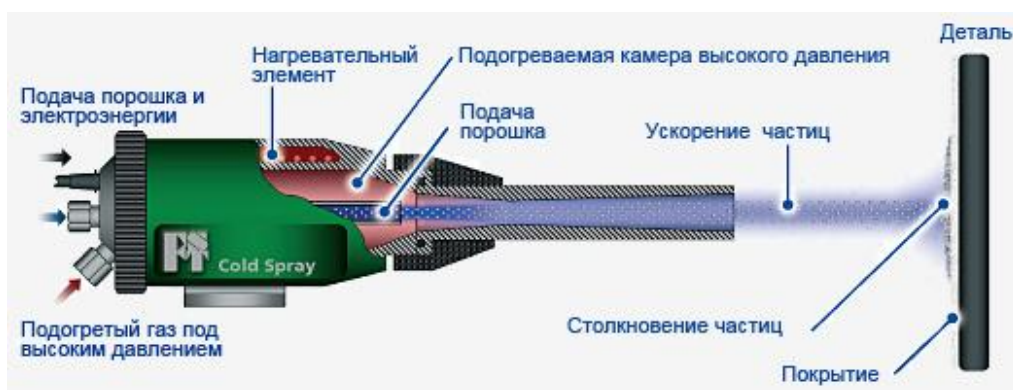
Рисунок 3.5 – Схема высокоскоростного газодинамического напыления
