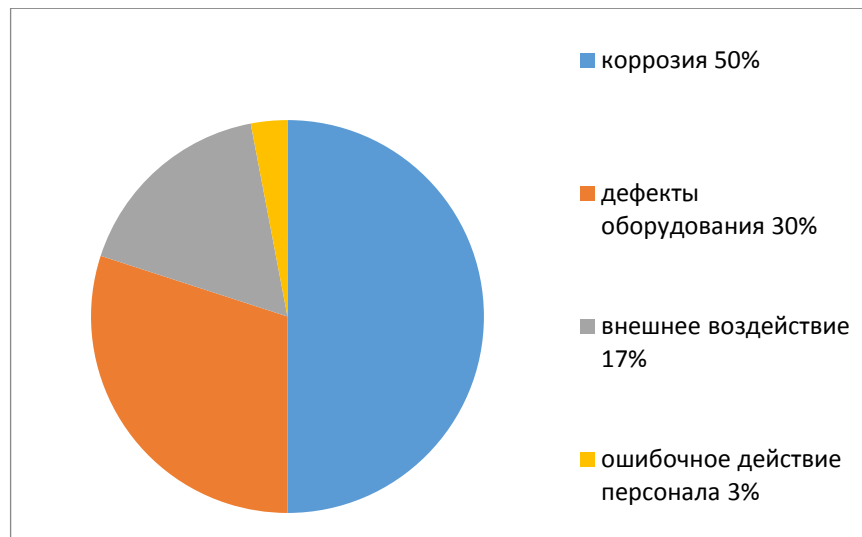
Рисунок 2.5 – Причины возникновения аварий на нефтепроводе по данным Ростехнадзор (2000 – 2012 гг)
