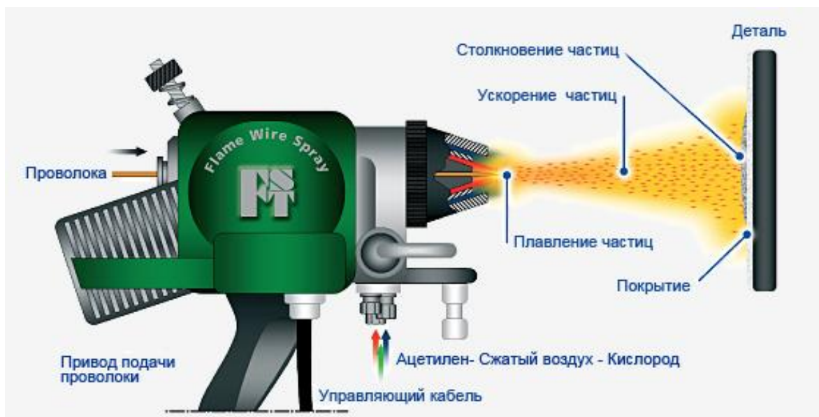
Рисунок 3.7 – Схема проволочного газопламенного напыления
