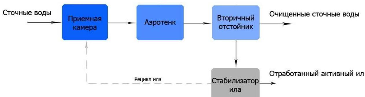
Рисунок 5 - Схема очистки сточных вод
