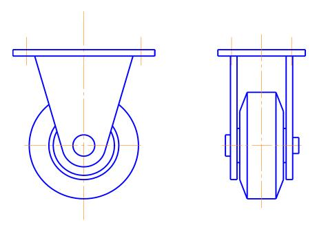
Рисунок 2.3 – Колесо 2Г-100-980 ГОСТ 11112-78 (неповоротное)
