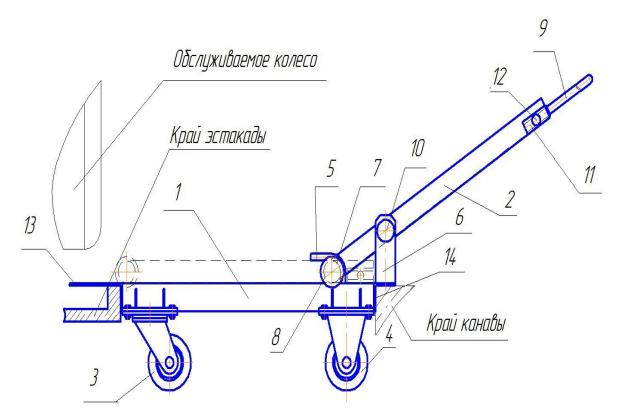
1-рама; 2-настил; 3- подвижное колесо; 4-неподвижное колесо; 5-крюк; 6-кронштейн; 7-труба; 8-шайба; 9-рукоять; 10-стопорный винт; 11-втулка; 12-стопорный винт; 13-опорный лист; 14-опорный уголок
