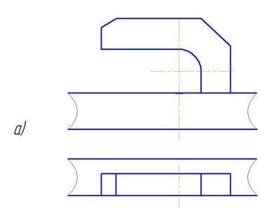
Рисунок 2.6.1 – а) Вариант исполнения крюка для фиксации настила
