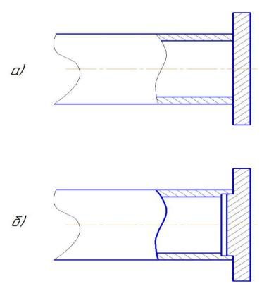
Рисунок 2.5 — Варианты исполнения соединения ограничительной шайбы с трубой настила
