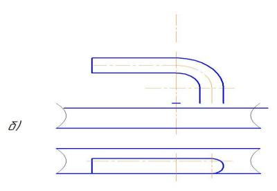
Рисунок 2.6.2 – б) Вариант исполнения крюка для фиксации настила
