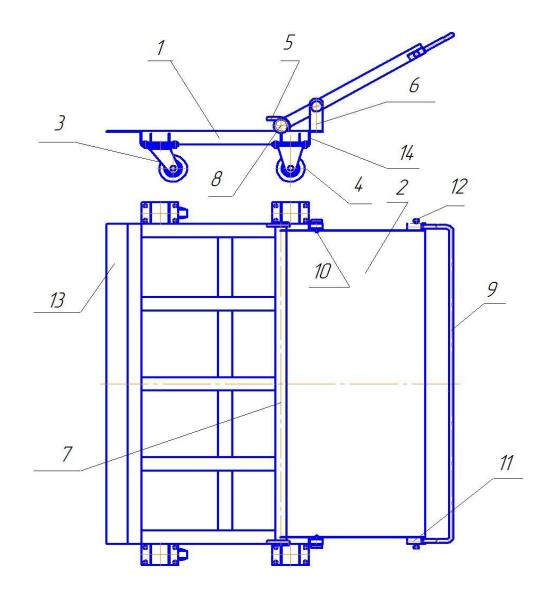
1-рама; 2-настил; 3-подвижное колесо; 4-неподвижное колесо; 5-крюк; 6-кронштейн; 7-труба; 8-шайба; 9-рукоять; 10-стопорный винт; 11-втулка; 12-стопорный винт; 13-опорный лист; 14-опорный уголок
