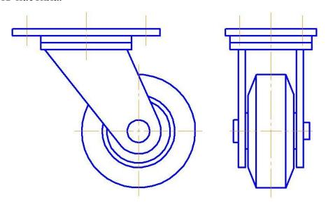
Рисунок 2.2 – Колесо 2В-100-980 ГОСТ 11112-78 (поворотное)
