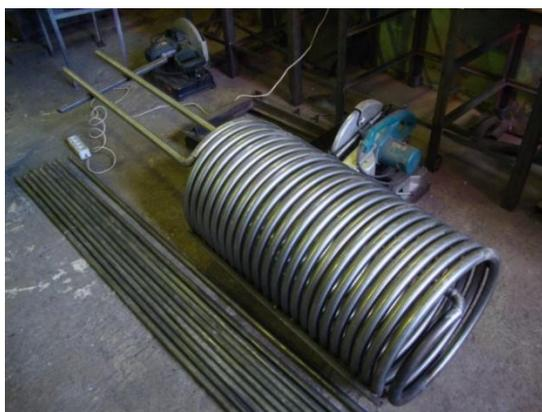
Рисунок 12 - Теплообменник-змеевик
