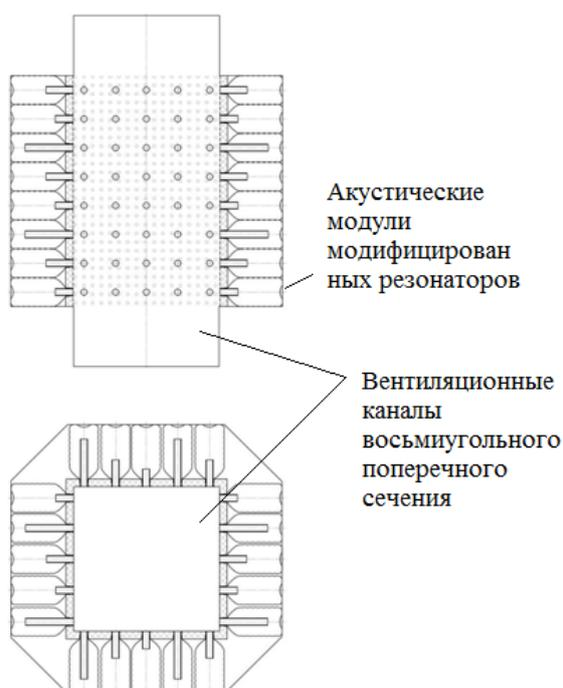
Рисунок 10 - Вентиляционный канал восьмиугольного поперечного сечения с интегрированными акустическими модулями
