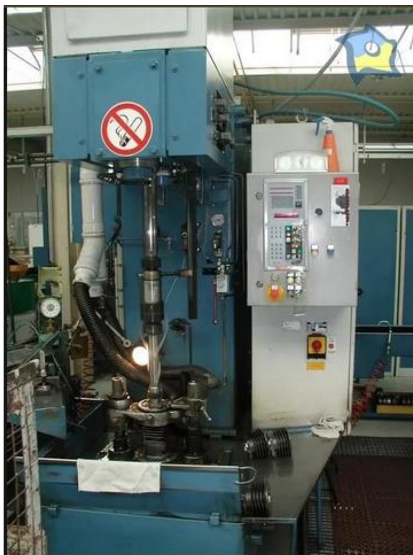
Рисунок 1.17 - Хонинговальный станок NAGEL VS8 - 50F.
