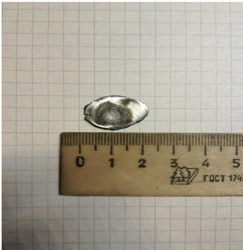
Рисунок 3.9 – Проба после атомно-эмиссионного спектрального анализа
