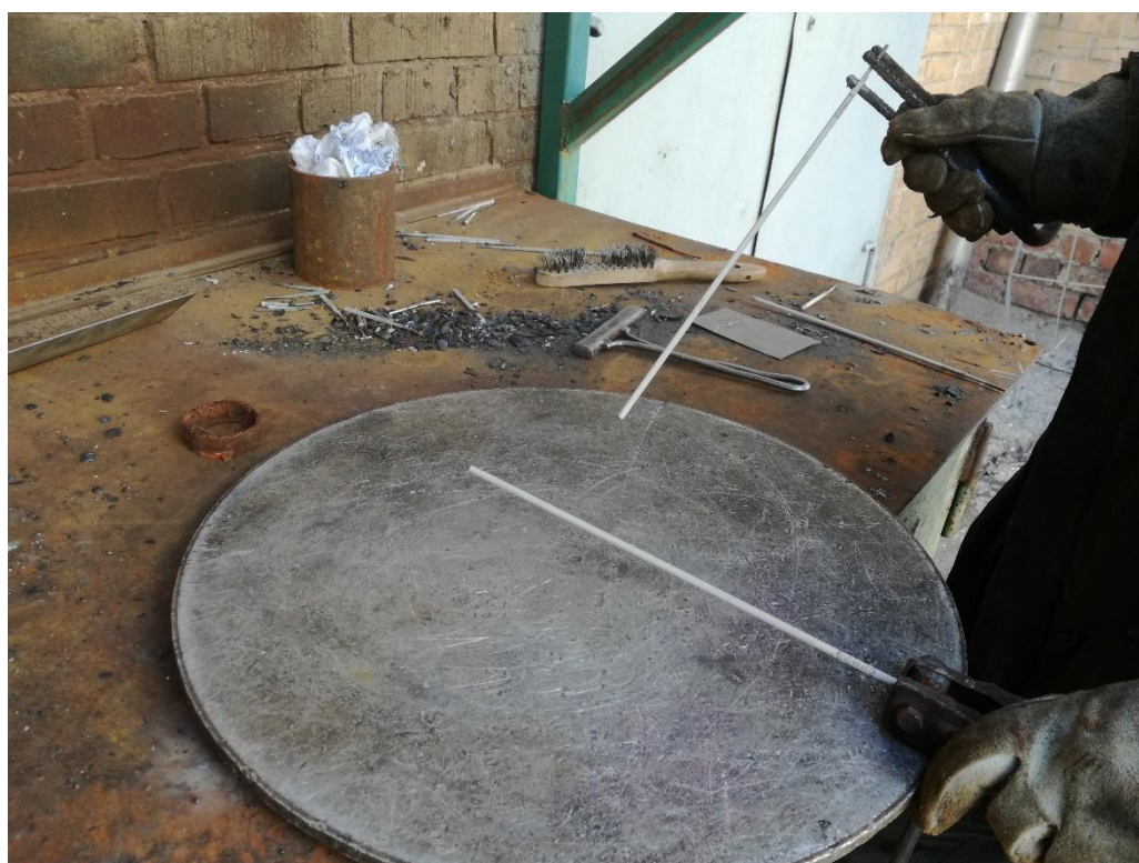
Рисунок 3.10 – Расплавление электрода дугой косвенного действия на алюминиевую пластину
