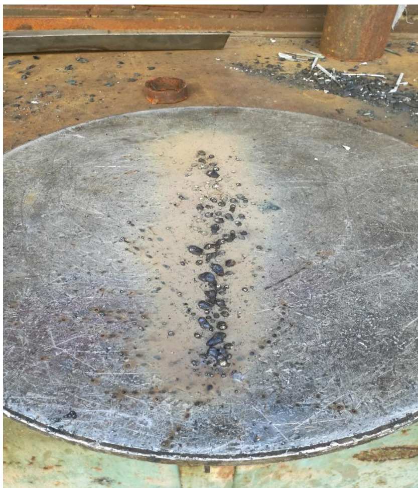
Рисунок 3.11 – Пробы полученные в ходе расплавления электрода
