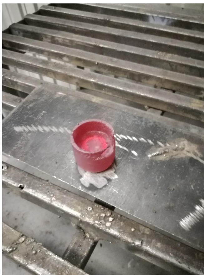
Рисунок 3.14 – Наплавка косвенной дугой в медную форму
