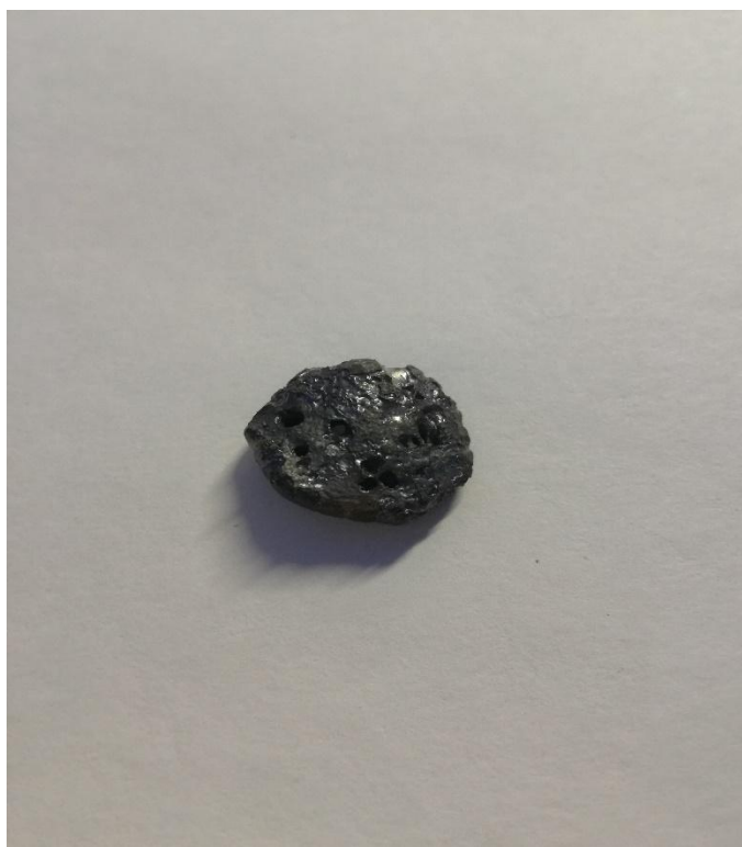
Рисунок 4.3 – Образец со множеством пор и сквозных отверстий.
