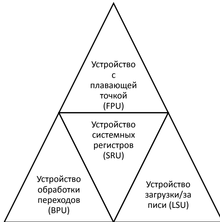
Рисунок 2.7 – Основные устройства – составляющие процессора Power PC 750.
