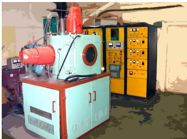
Рисунок 6 – ионно-плазменная установка с тремя катодами
