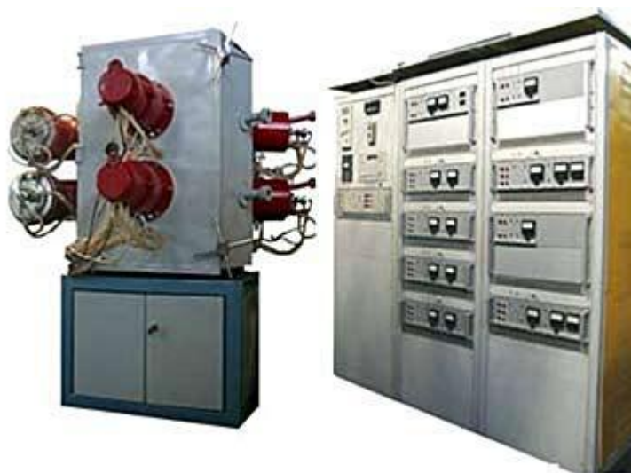
Рисунок 7 – Модернизированная установка ННВ 6.6-И4 с шестью катодами
