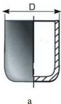
Рисунок 5 – Металлическая гильза для создания зубных протезов: а – схема; б – фотография гильзы
