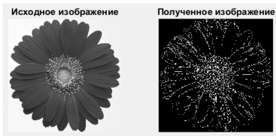
Рисунок 1.2 – Пример работы оператора Canny
