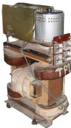
Рис. 16. Внешний вид сварочного трансформатора ТС-150 (изготовил К.В. Моторин)
