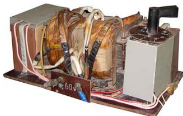
Рис. 3. Внешний вид сварочного трансформатора ТС-100 (изготовил студент С.И. Курисев)
