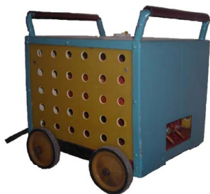
Рис. 22. Сварочный трансформатор ТС-125 (изготовил М.А. Анисимов, 2008)
