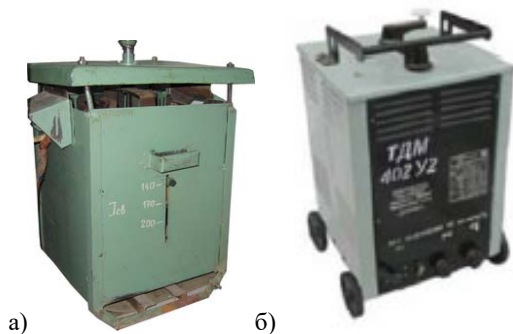
Рис. 19. Сварочный трансформатор ТС-300 (а) и ТДМ-402 У2 (б)
