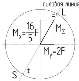
Продлив  $M_{\Sigma}$  до пересечения с внешней окружностью, получим силовую линию. Опасные точки  $L, S$  лежат на пересечении силовой линии с внешней окружностью круглого сечения. Напряжения в этих точках равны по величине, но противоположны по знаку.
