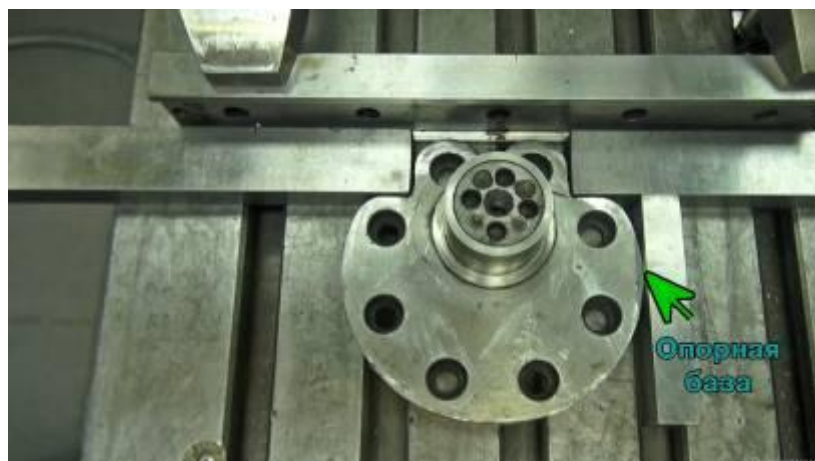
Рисунок 28- Использование точки опорной базы на непрямолинейной поверхности
