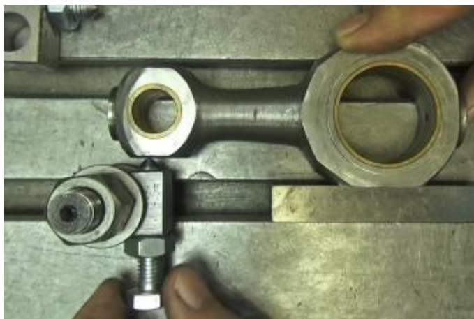
Рисунок 18 - Увеличение устойчивости с помощью регулируемой упорной точки
