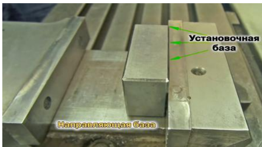
Рисунок 41- Соединение с плоскостью направляющих тисков
