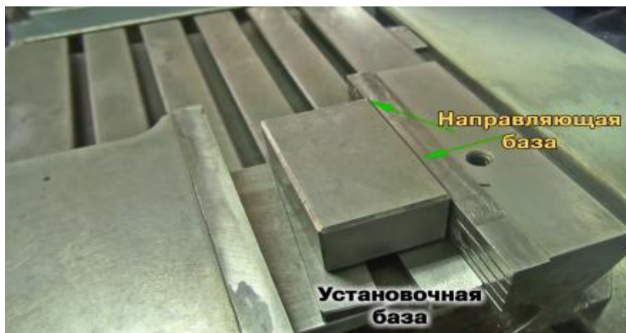
Рисунок 40- Соединение точки направляющей базы с деталью
