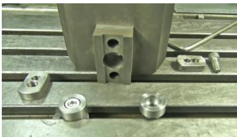
Рисунок 11- Ступенчатые втулки используются в качестве базирующих точек
