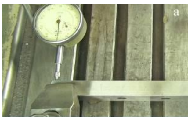
Рисунок 17- Установка детали по направляющей базе способом ударных подвижек
