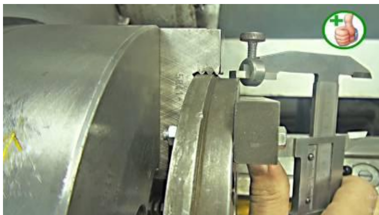
Рисунок 34- Измерение штангенциркулем с помощью мерной плитки
