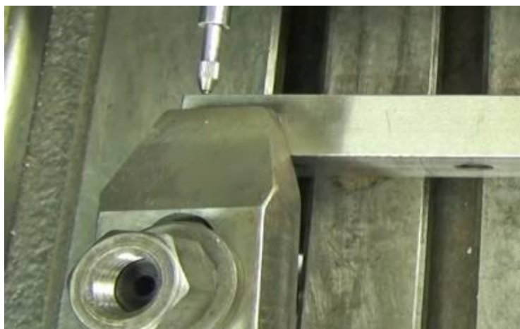
Рисунок 16- Первая точка, напротив которой ставится индикатор
