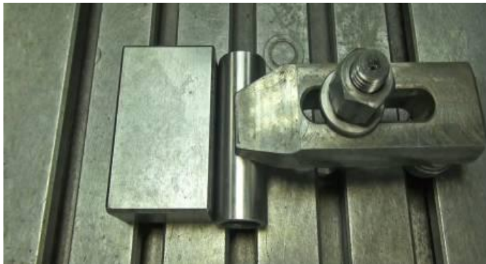
Рисунок 8- Пример направляющей базы
