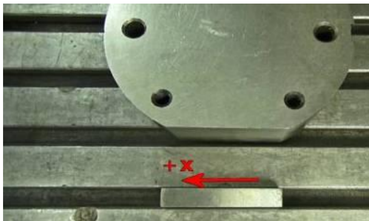
Рисунок 10- Получение базирующей линии с помощью плоскопараллельной призмы
