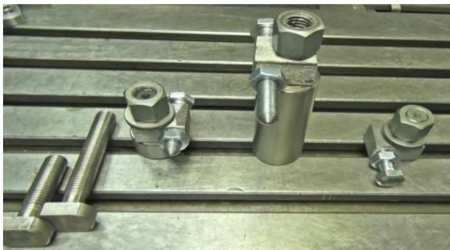
Рисунок 13- Базирующие точки создаются с помощью втулок
