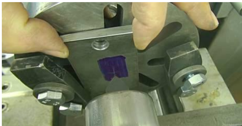
Рисунок 32- Соединение точки пересечения разметочных рисок с пинолью задней бабки
