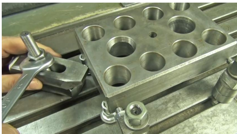
Рисунок 27- Пример произвольно собранного приспособления
