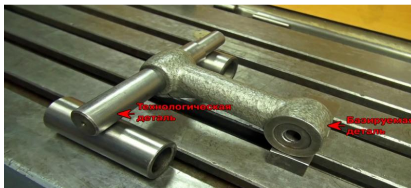
Рисунок 3- Создание искусственной базы с помощью технологической детали.
