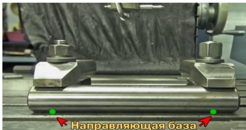
Рисунок 5- Пример направляющей базы
