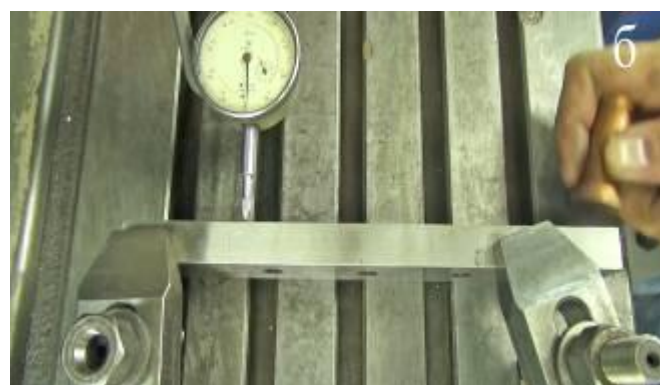
Рисунок 17- Установка детали по направляющей базе способом ударных подвижек
