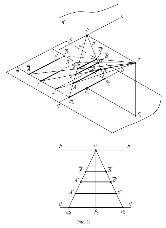
На основании положения элементарной геометрии о свойствах равновеликих фигур, треугольник  $m_0 P n_0$  можно заменить на треугольник  $X_1 h X_2$ . При этом единица измерения  $X_1 X_2$ , равная AB, вынесена за пределы вертикальной границы плоскости картины (рис. 39).
