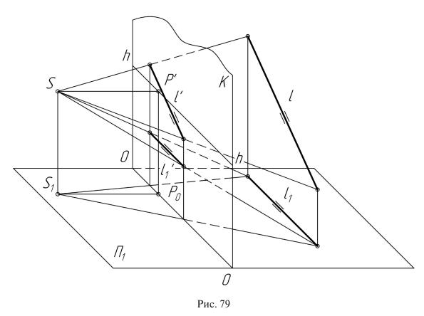
Если лучи света расположены параллельно плоскости картины, то перспективы лучей будут параллельны между собой и параллельны заданному лучу, а их вторичные
