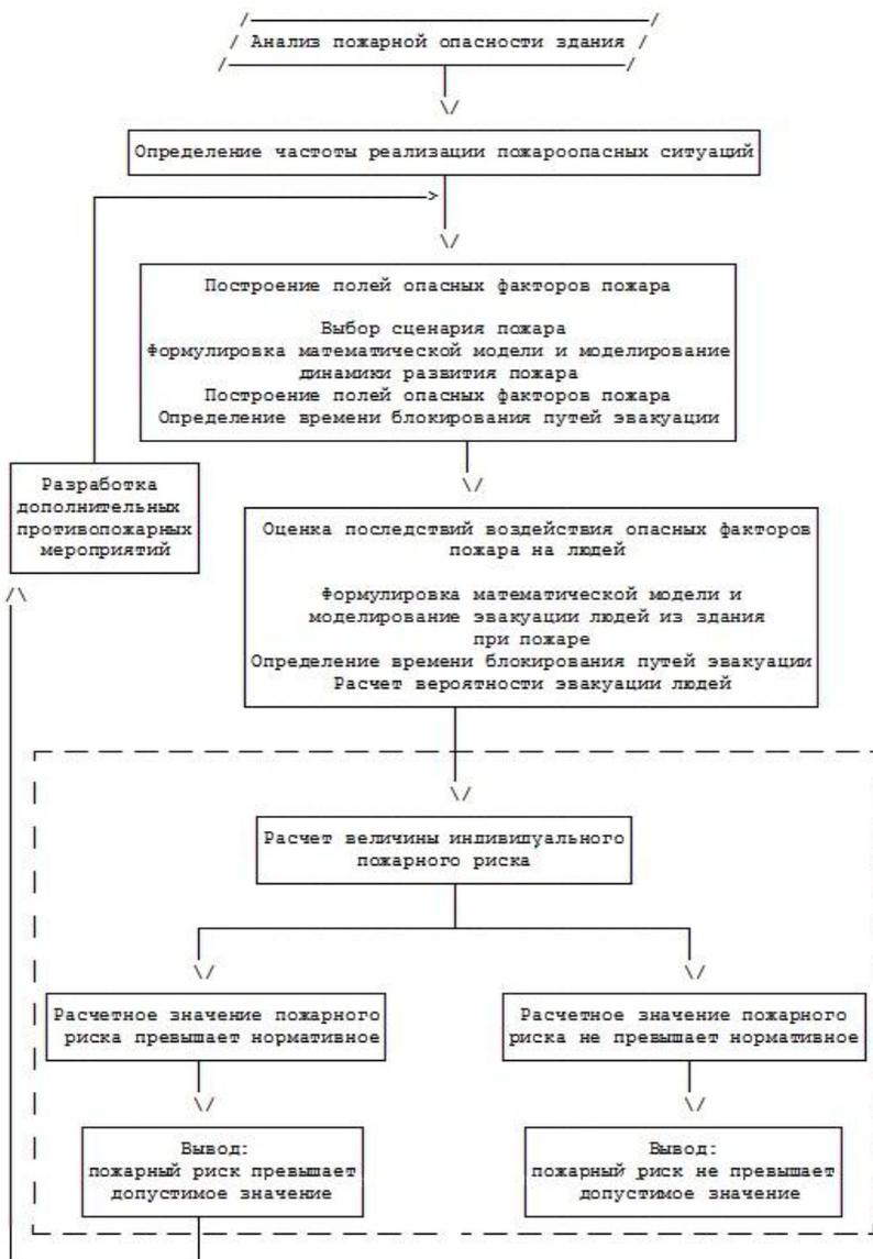
Рис. 1. Алгоритм расчета индивидуального пожарного риска
