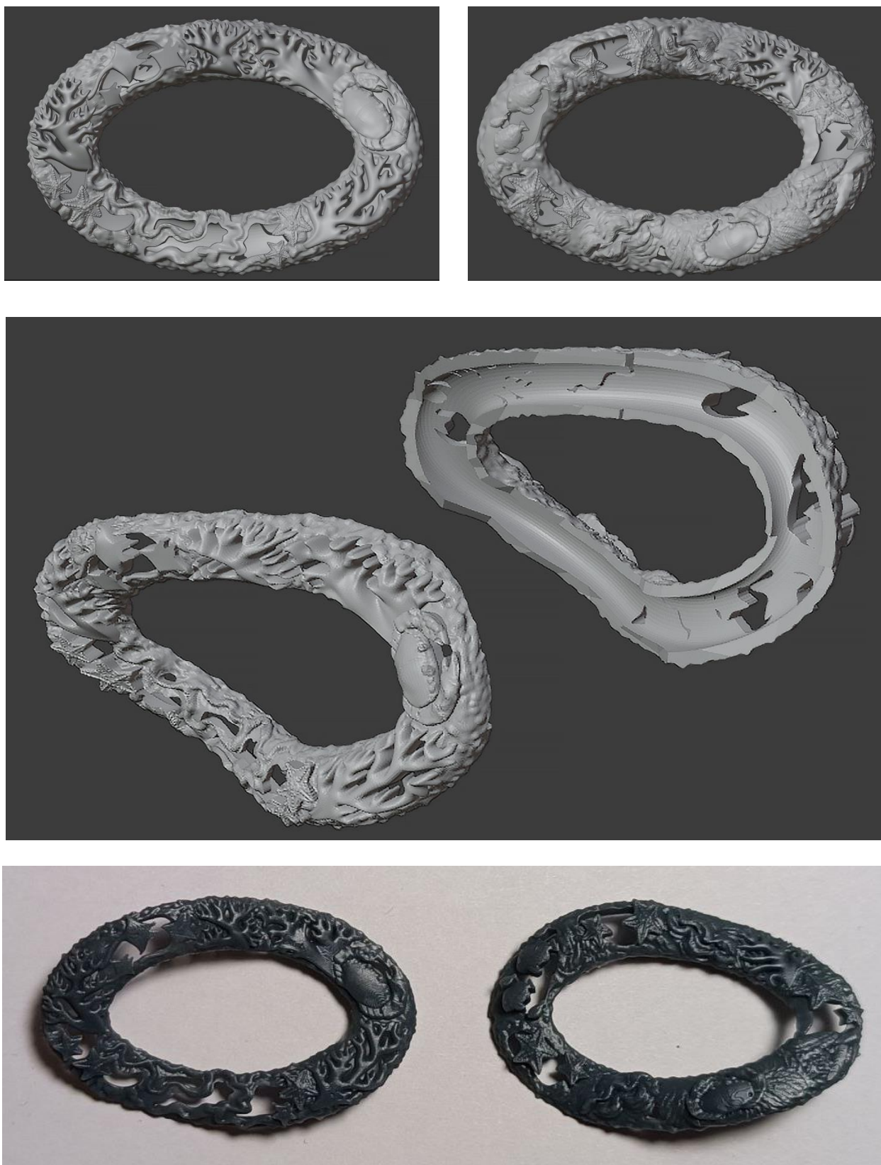
Рисунок Б.14 – Создание звена цепи, подготовка к 3D-печати и распечатанные 3D-модели
