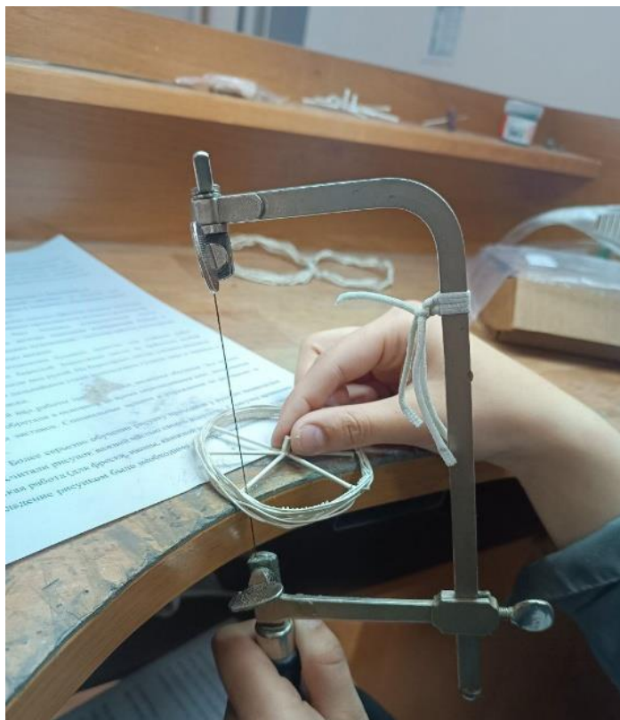
Рисунок Г.6 – Спиливание литников
