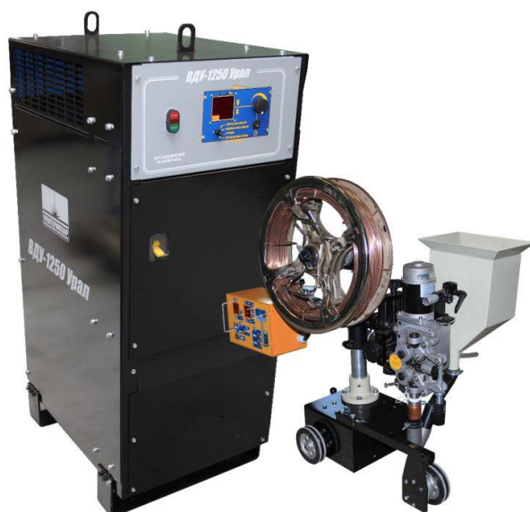
Рисунок 18 – Общий вид комплекта оборудования для АФ сварки
