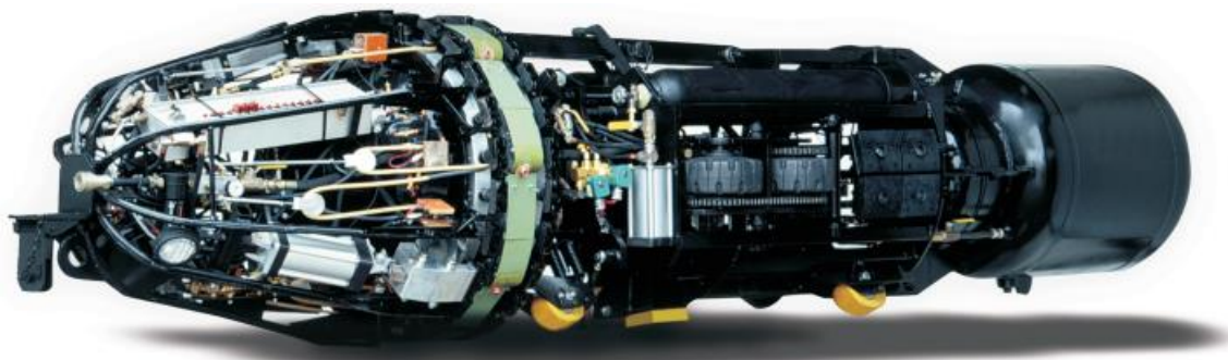
Рисунок 16 – Общий вид внутритрубной сварочной станции IWM
