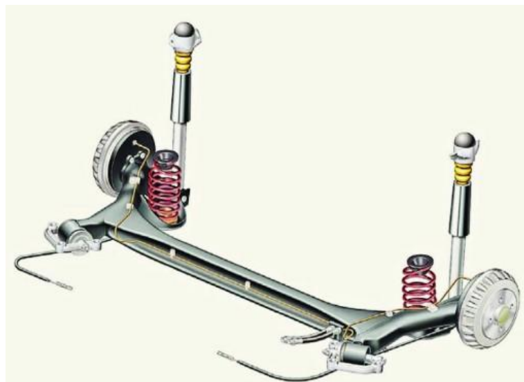
Рисунок 4 – задняя подвеска автомобиля Audi A2 с торсионной балкой
