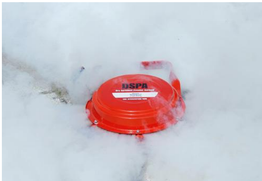
Рисунок 7 – Срабатывание генератора огнетушащего аэрозоля АГС-11/5
