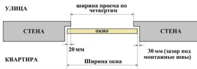
Рисунок 5 - Схема выполнения замеров оконного проема
