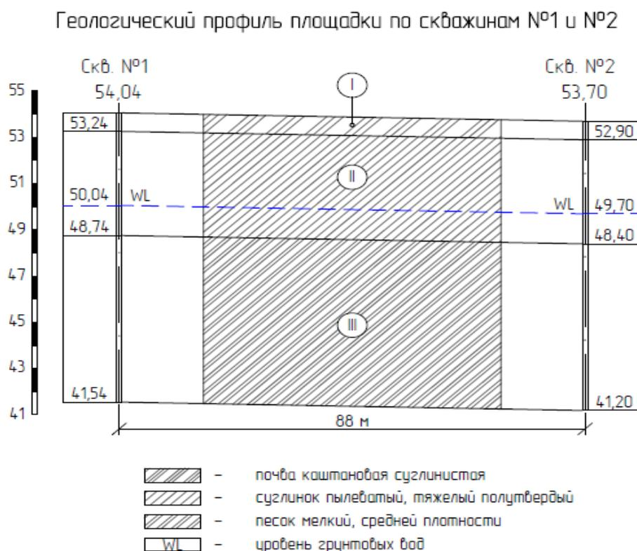
Рисунок 2 – Геолого-литологический разрез по створу скважины 1-2
