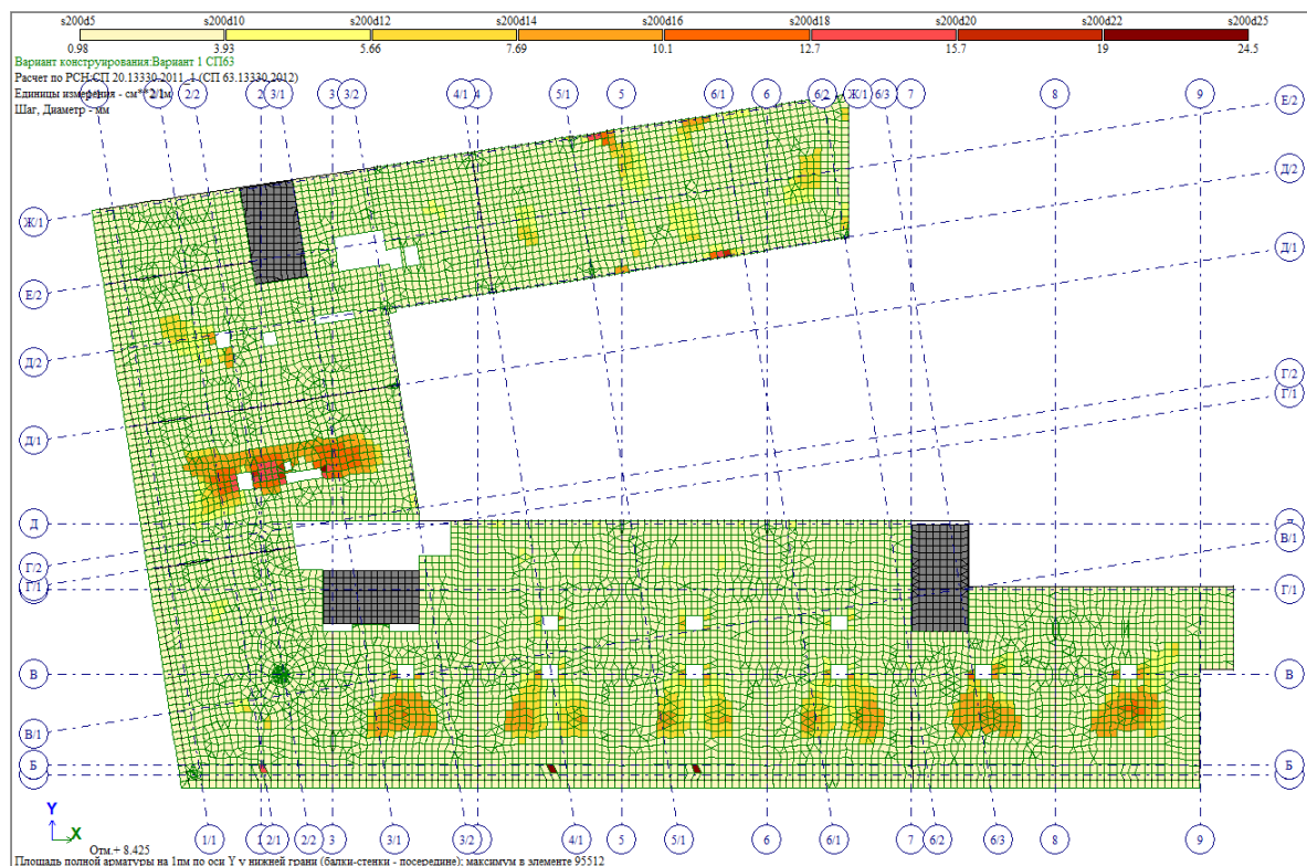
Рисунок 6 - Площадь нижнего армирования вдоль цифровых осей
