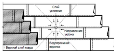
Рисунок 13 – наклейка слоев кровли
