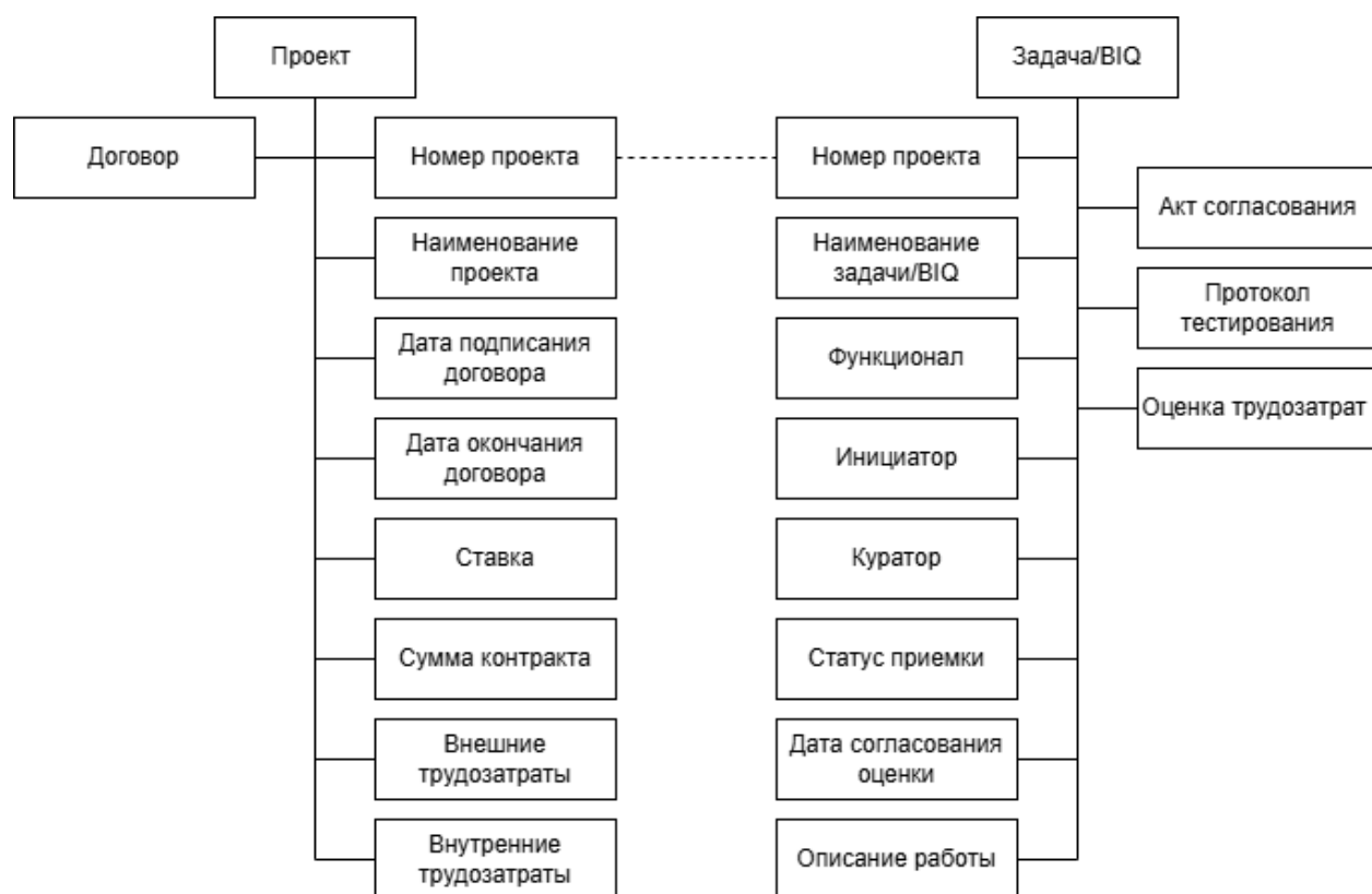
Рисунок 5 – Схема представления данных в формате NoSQL
