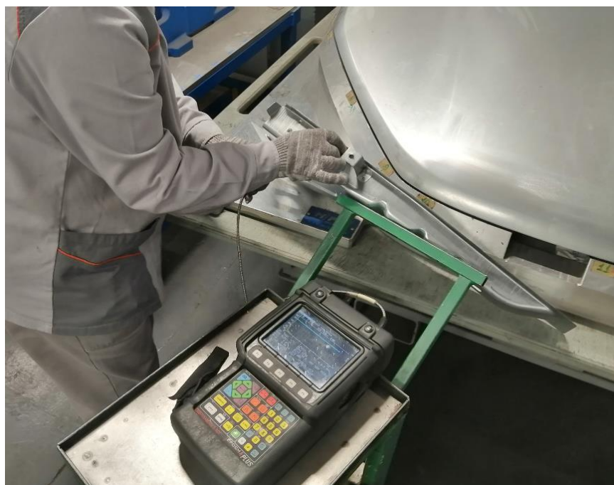
Рисунок 14 – Проведение проверки качества точек сварки с помощью ультразвукового дефектоскопа
