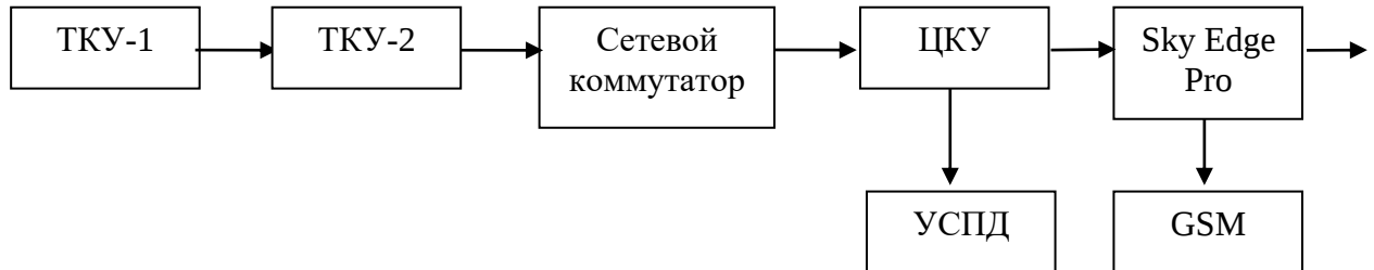
Рисунок 16 – Структура и взаимосвязь отдельных модулей второго уровня системы ПС 220 кВ для расчета надежности
