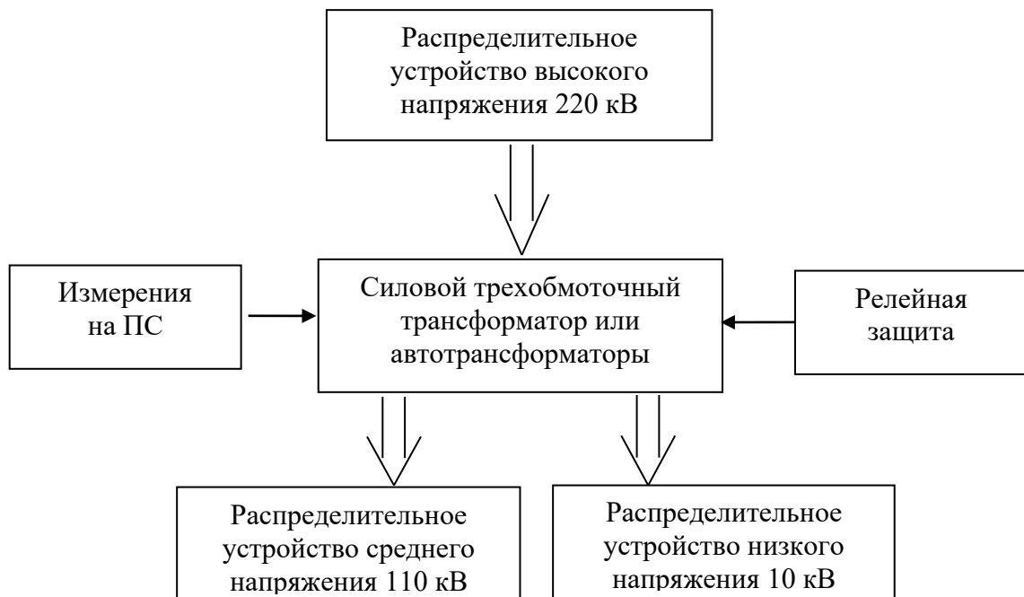
Рисунок 3 – Структура и взаимосвязь отдельных модулей для ПС 220 кВ
