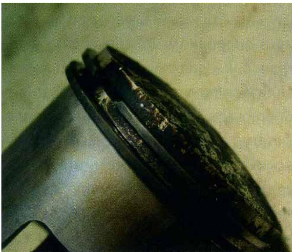
Рисунок 7 – Последствия износа поршня при несоответствии типа смазки, рекомендуемой производителем двигателя
