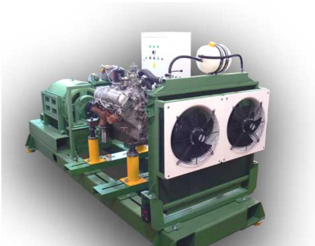
Рисунок 4 – Стенд горячей обкатки ОТС-2
