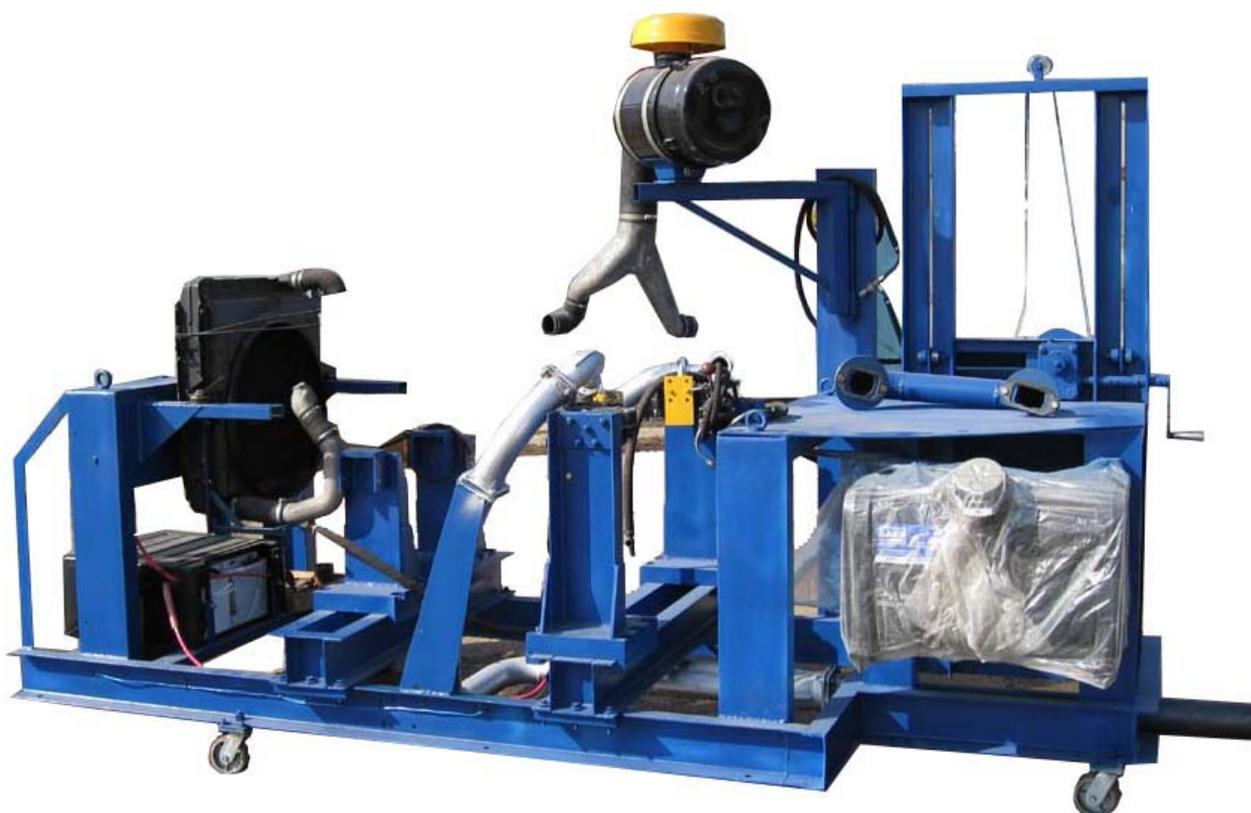
Рисунок 1 – Стенд горячей обкатки двигателя СОД.1001.0000.000
