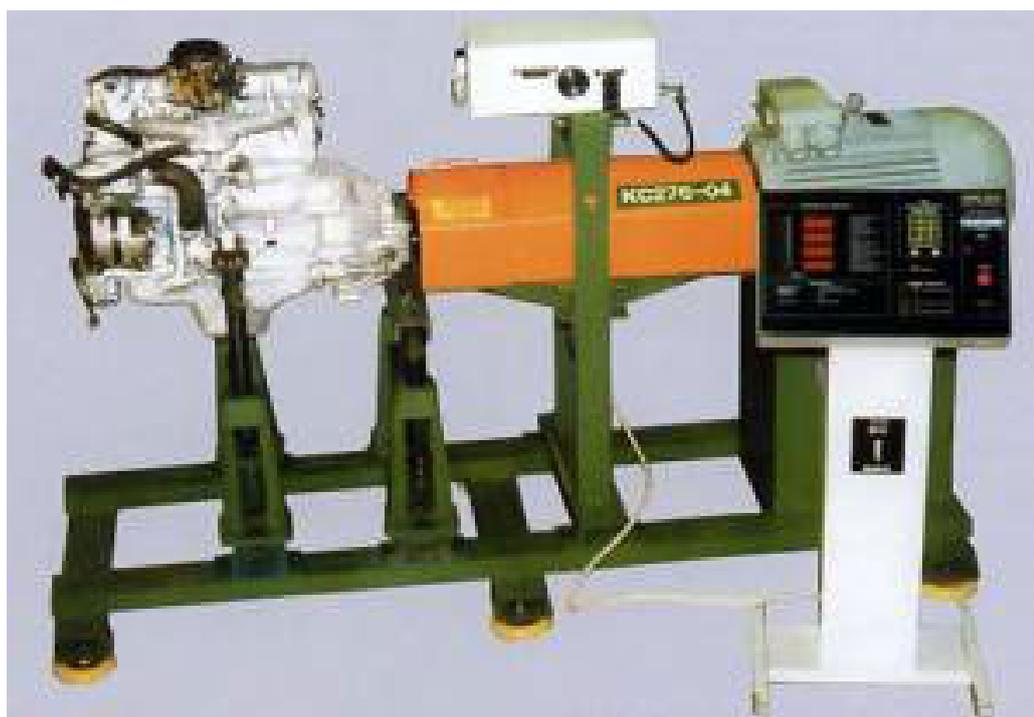
Рисунок 2 – Стенд для холодной и горячей обкатки двигателя КС 276-04
