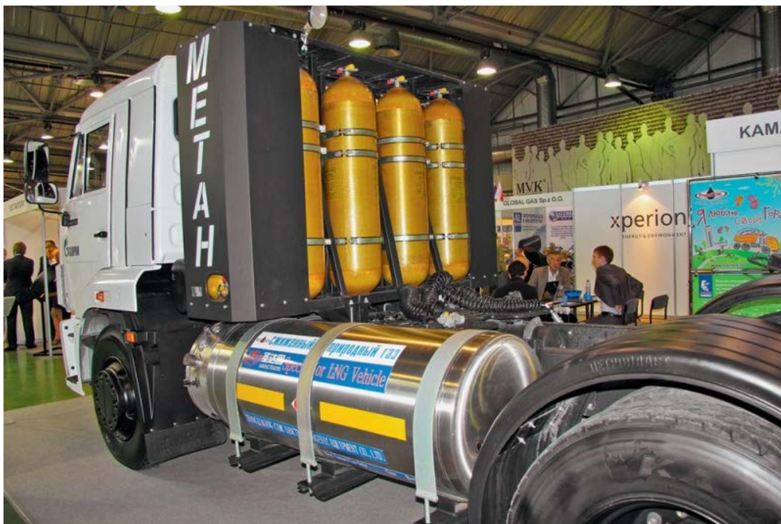
Рисунок 2 – Седельный тягач КамАЗ-65116 на КПП/СПГ с криобаком для сжиженного метана
