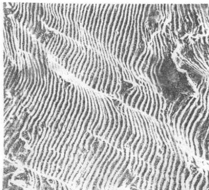
Рис. 3.5. Усталостные бороздки на поверхности излома стали
