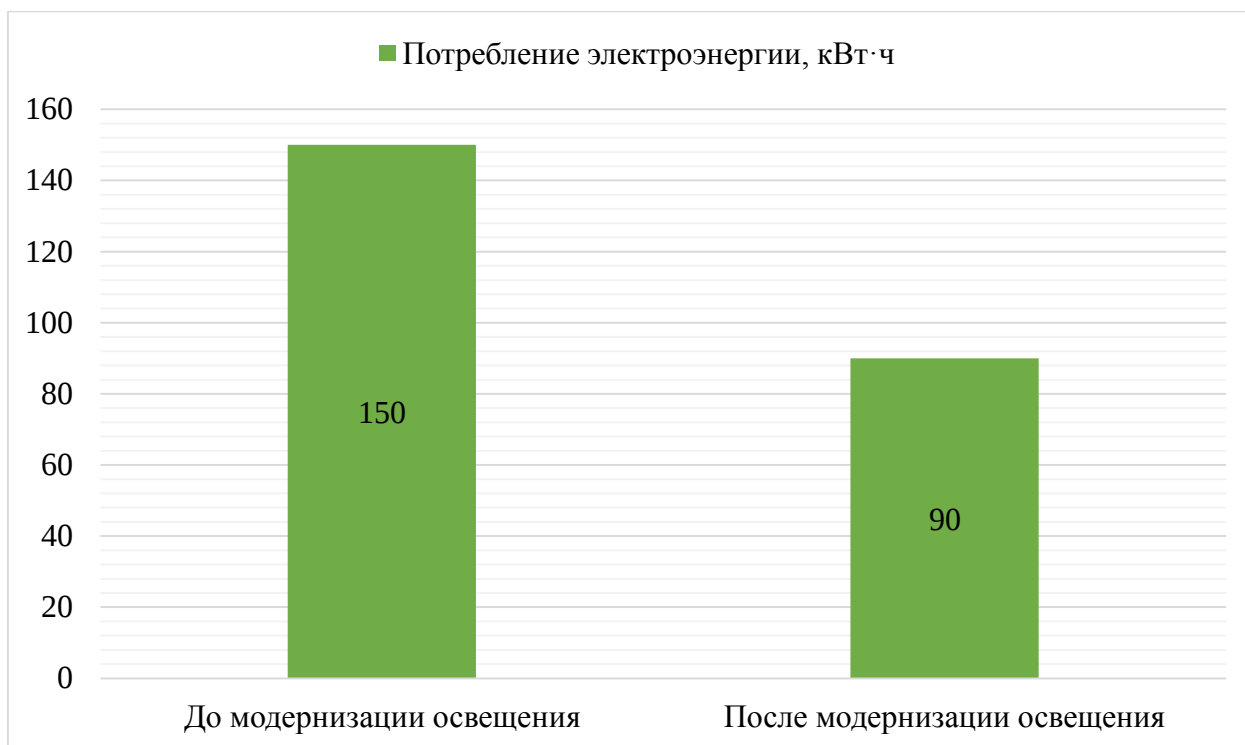
Рисунок 11 – Результаты предварительной оценки модернизации системы освещения цеха №7 АО «ПО «Севмаш»
