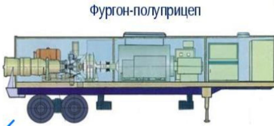
Рисунок 1 – Внешний вид ПАЭС–2500 кВт [15]
