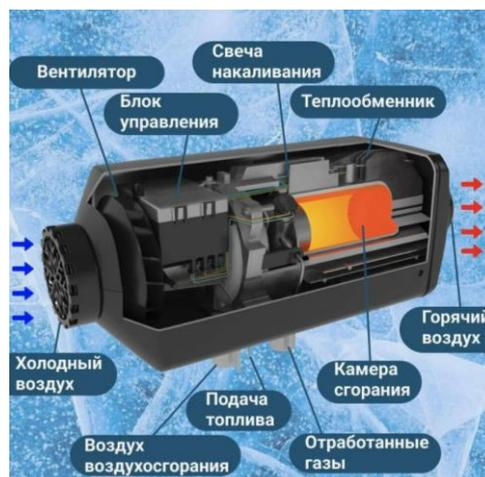
Рисунок 18 – воздушный дизельный отопитель [2]
