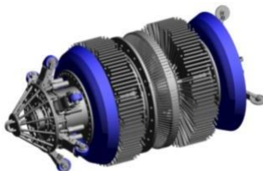
Рисунок 9 – Магнитный дефектоскоп продольного намагничивания
