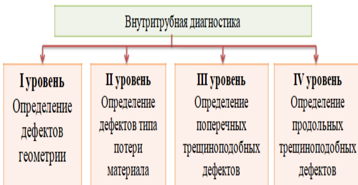
Рисунок 13 – Четырёх уровневая схема внутритрубной диагностики
