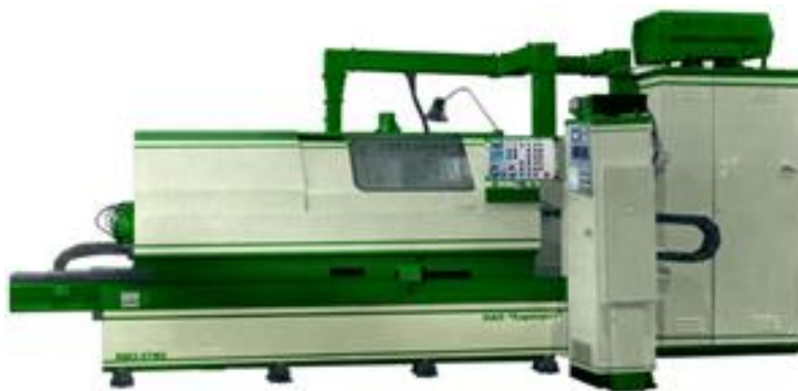
Рисунок 22 – Шлифовальный станок для перешлифовки распределительных валов
