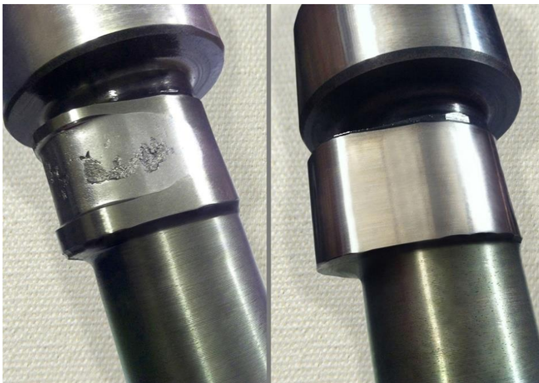
Рисунок 6 – Пример дефекта на рабочей поверхности вала
