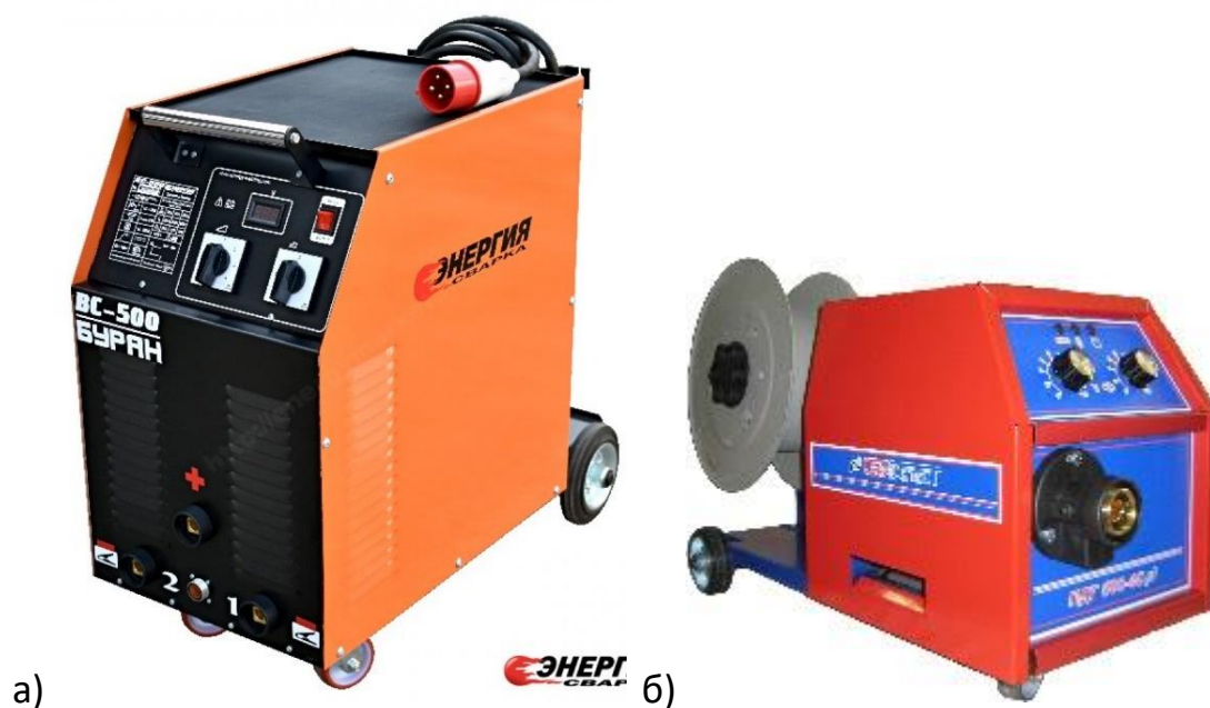
Рисунок 7 – Сварочный выпрямитель ВС-500 (а) и механизм подачи проволоки ПДПГ-500
