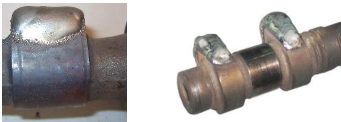
Рисунок 8 – Наплавленная рабочая поверхность вала
